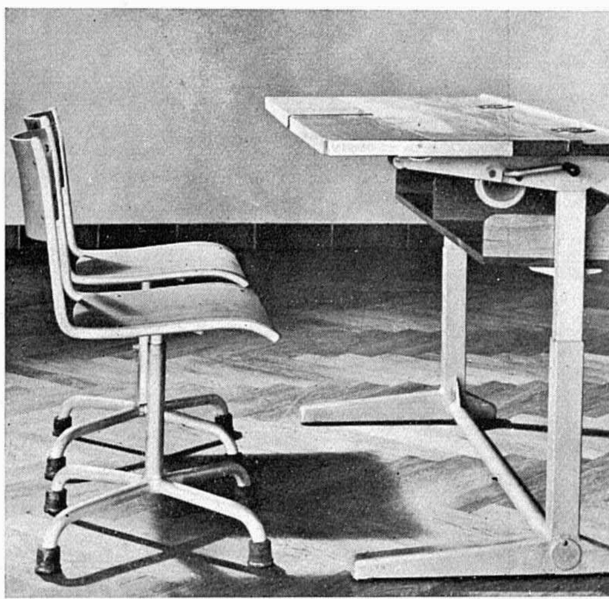
Zürcher Schultisch, Mod. B, für das 4.—9. Schuljahr. Flach und relief stellbare Tischplatte für den Unterricht nach dem Arbeitsprinzip (zeichnen, kleben, schneiden, modellieren usw.). Tischplatte in der Höhe verstellbar, dadurch Anpassung an die Schülergrösse; Wegfall der jährlichen Mobiliariumstellungen. Tischplatte mit zwei Bücherklappen aus Eichenholz, lackiert. Gestell Vierkantstahlrohr metallgespritzt
